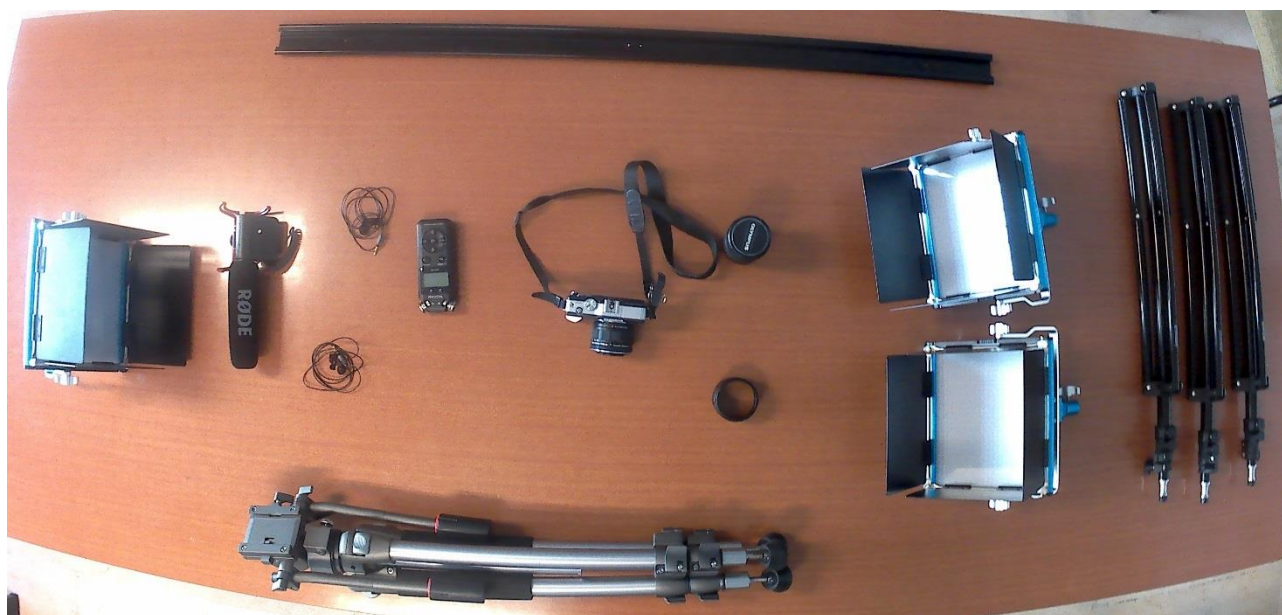
Imagen 1. Equipo de grabación escolar. Cámara de objetivos intercambiables (14-42 mm; 40-150 mm). Micrófonos de solapa. Micrófono direccional. Grabadora externa. Trípodes. Focos Led. Deslizador.
